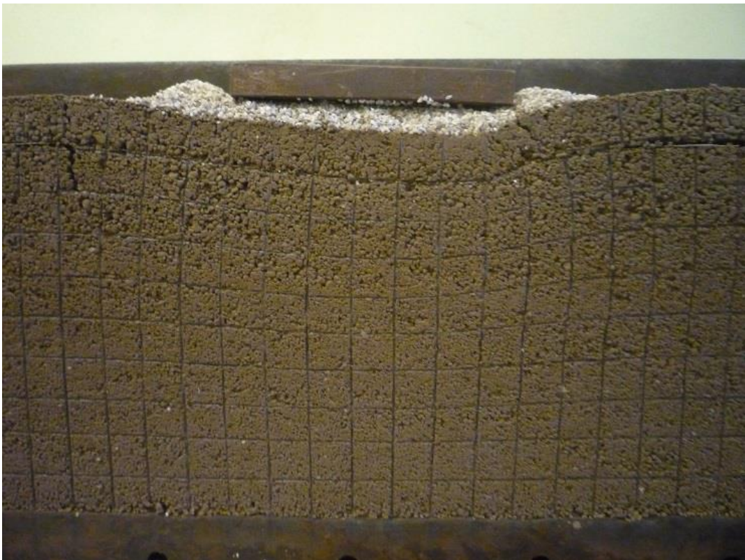
Рисунок 4.4 – Фотографії характерного деформування моделей: а) непідсиленої ґрунтової основи; б) підсиленої мікропалею
