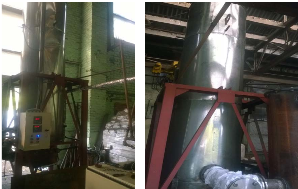
Рис. 2. Полупромышленный образец модернизированного газогенератора
