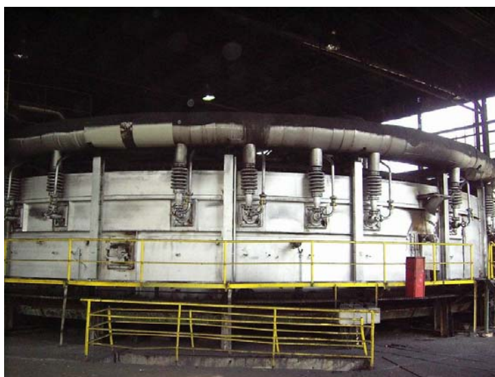
Рис. 1. Узлы подвода природного газа и воздуха к горелкам кольцевой печи
