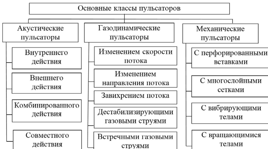
Рис. 4.– Классификация пульсаторов и принцип их реализации
