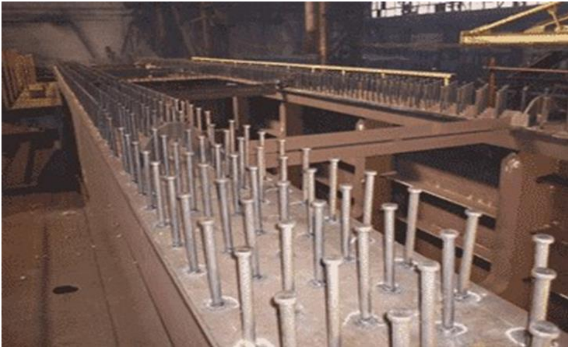
Рисунок 1.11. Анкера приварені напівавтоматичним методом
