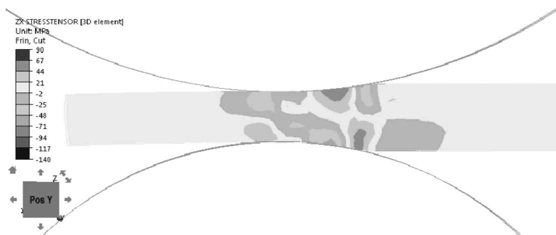
Rys. 5. Rozkład tensora naprężenia dla walcowania z dwoma rodzajami asymetrii wsadu o wysokości początkowej h_0 = 10 mm; \varepsilon_w = 0,25 ; a_v = 1,3 ; a_g = 1,3
