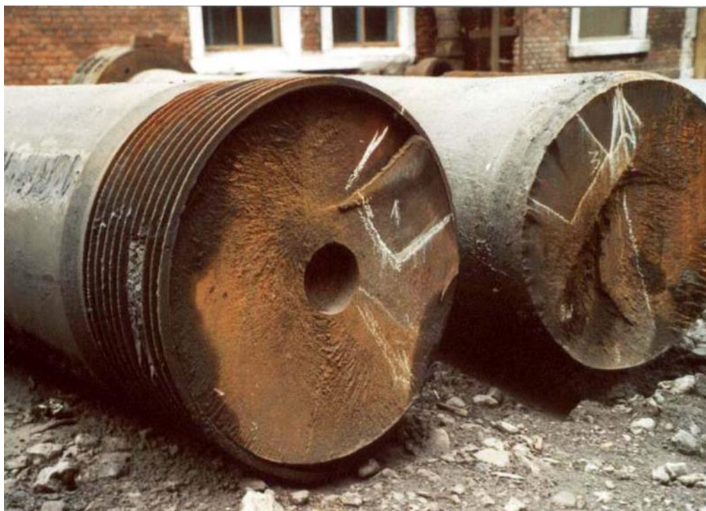
Рис. 4.4 - Втомний характер зламів колон [104]
