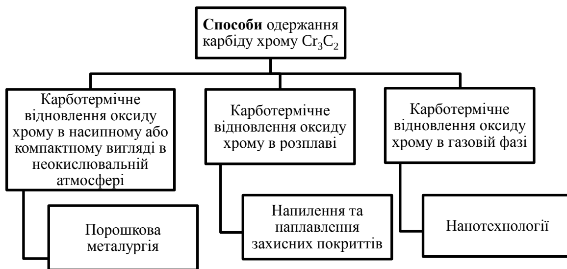
Рисунок 5.2. Способи одержання карбіду хрому Cr 3 C 2 та його використання
