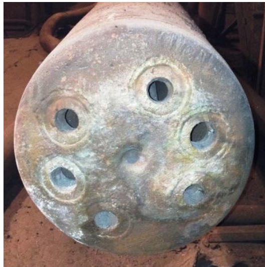
Рис. 1.14 - Конструкція (а) та вигляд (б) 6-ти соплового наконечника водоохолоджуваної гарнісажної фурми з згрупованими по три соплами Лавалля: 1, 3 - патрубки подачі та відводу охолоджувальної води; 2 - патрубков подводу азоту; 4, 5 - верхня та нижня чаші; 6, 7 - вкладиші з соплами Лавалля d_{\text{вих}}=43 мм та d_{\text{кр}}=37 мм відповідно
