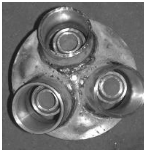
Рис. 1.19 – Газоохолоджувана газопорошкова азотно-киснева гарнісажна фурма [73]: 1, 2 – тарілі наконечника; 3 – обойма; 4 – кільцеве сопло Лавалля; 5, 6 – сопло типу «труба в трубі»; 7 – рухомий фіксатор; 8, 9, 10 – труби; 11, 12 – фіксатори
