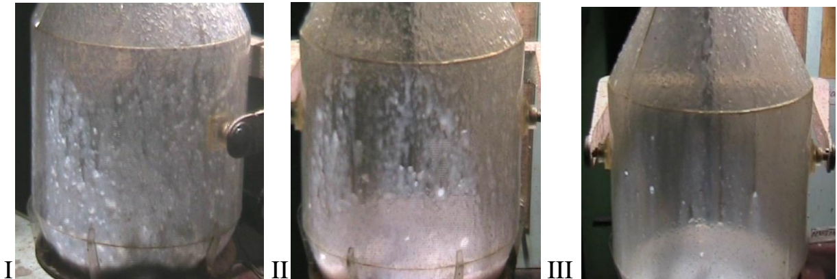
Рис. 3.3 - Вигляд покриття, нанесеного на стіни моделі конвертера за режимами I - III (рис. 3.2) при висоті наконечника фурми у 15, 25 та 40 кал. відповідно
