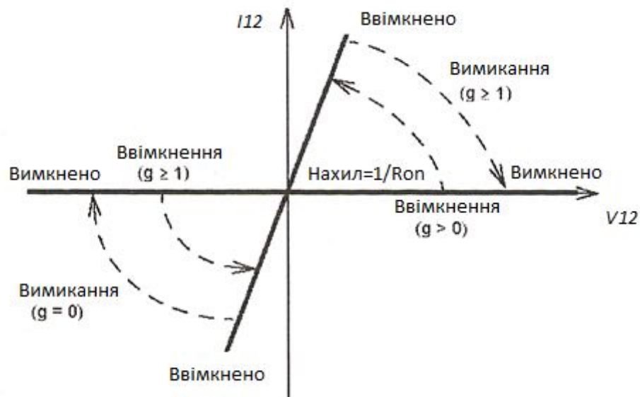
Рисунок 2.5 – Статичні вольт-амперні характеристики моделі ключа
