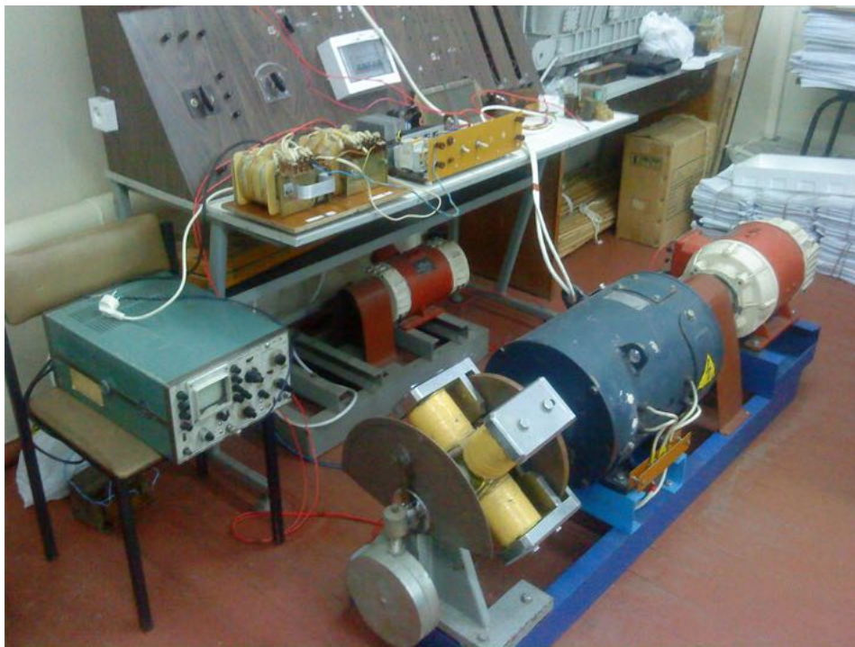
Рисунок 1 – Фото спеціального стенду імпульсного перетворювача для фізичного моделювання тягової передачі
