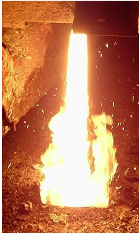
Рисунок 4.3 – Порушення компактності характеру витікання струменя металу («віяла»)
