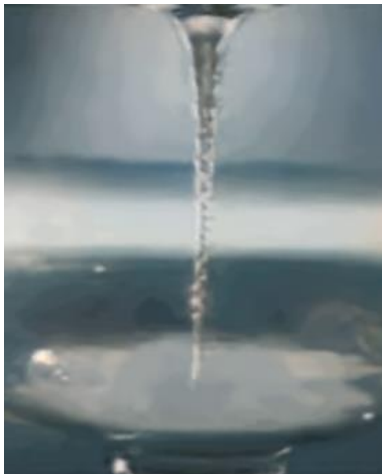
Рисунок 3.16 - Форма вихрової вікнини при підвищенні рівня моделюючої рідини
