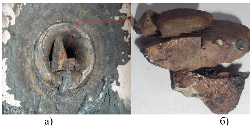
Рисунок 3.8 – Вид змінного стакана-дозатора із фрагментами зруйнованої ZrO_2 -вставки верхнього стакана-дозатора (а) вилучені з каналу дозатора фрагменти зруйнованої ZrO_2 -вставки (б).
