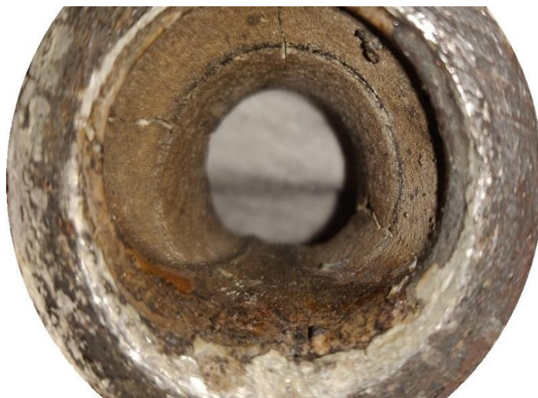
Рисунок 3.26 – Локальний знос (розмив) калібрувальної вставки нижнього стакан-дозатора внаслідок утворення застійної зони в області ковзання
