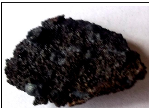
Рисунок 3.7 – Витягнутий з каналу стакана-дозатора фрагмент футерівки з виділеннями краплеподібних включень сталі
