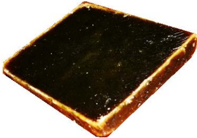
Рисунок 2.6 – Зовнішній вигляд зразка, який імітує робочу футерівку проміжного ківша
