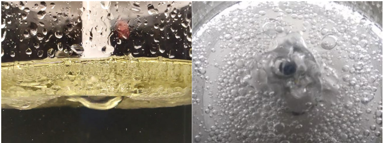
Рисунок 2.5 – Продувка через модель графітованого порожнистого електрода з об'ємною витратою газу 0,5 \text{ м}^3/\text{год} при висоті шлаку 14 мм:
