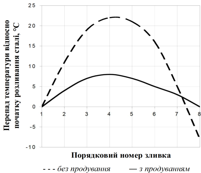
Рисунок 1.7 – Динаміка перепаду температури сталі під час розливки [17]
